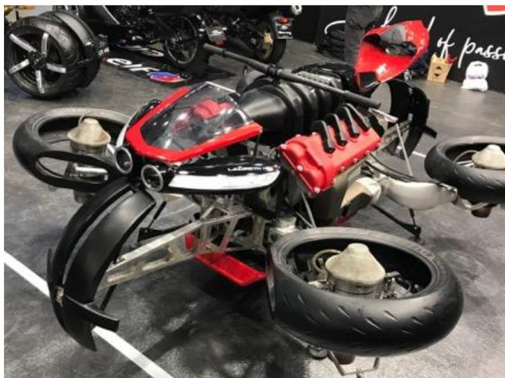
Moto à roues, certes, mais chaque moyeu est équipé d'un mini-réacteur. La moto se "disloque" automatiquement pour mettre les réacteurs à l'horizontale et peut décoller comme on peut le voir sur le site <https://www.lazareth.fr/neomobilite/moto-volante/>, où des vidéos, dont la photo ci-dessous est extraite, illustrent cette possibilité !
